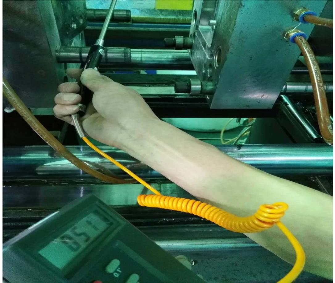
1、开机前确认模具温度及模具各个信号开关；
