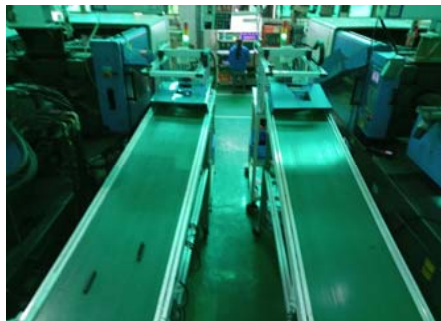
小流水线上进行模号区分 (避免模号混一起)
