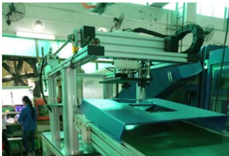
自动切水口加工水口 (不用人工作业)
