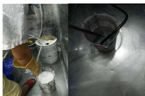
4. 将吸头放入洗枪水中循环清洗油泵直到洗枪水清澈
